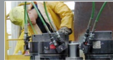
Öffnen und Schließen von Druckbehältern mit Schraubenspannvorrichtungen Opening and closing of pressure vessels with bolt tensioners
